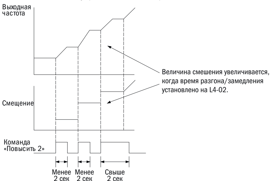
Рисунок 6.39. Повышение 2 / Понижение 2 смещения, если L4-01 > 0,0 Гц
