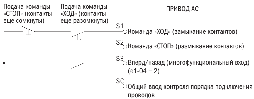
Рисунок 6.44. Схема трехпроводного подключения управлением преобразователя
