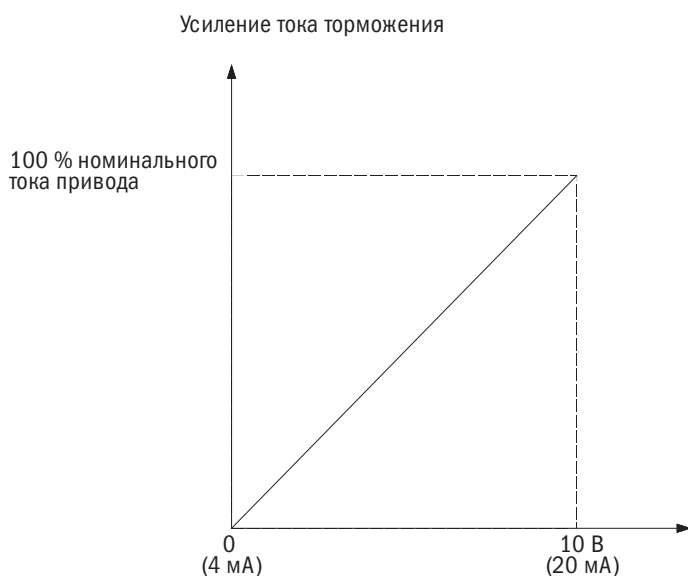
Рисунок 6.65. Торможение постоянным током с использованием аналогового входа
