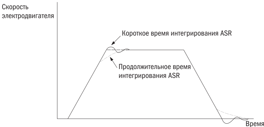
Рисунок 6.27. Отклик для времени интегрирования ASR
